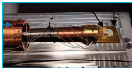
Caractérisation d'un capteur SHM sous environnement cryostat He liquide
