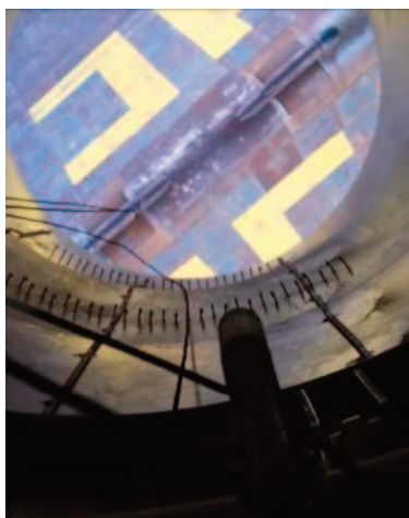
Instrumentation pour les mesures de température dans le guide-jet.
