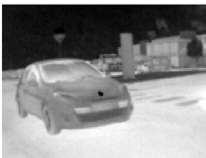
Première image infrarouge avec un microbolomètre de pas pixel 8,5 µm [QVGA (320 x 240 pixels)], optique de longueur focale 3,9 mm ouverte à F/1,2).
