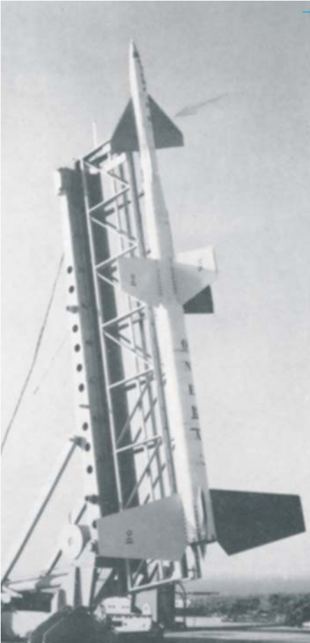
■ Figure 3 : Tir de fusée aux îles du Levant pour l'étude de l'échauffement d'une aile à Mach 2 pour le projet Concorde. Missile D-6 expérimental à 3 étages propulsés par fusées à poudre sur sa rampe de lancement.
