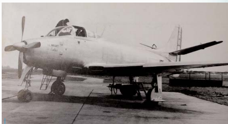
■ Figure 7 : Avion Breguet 960 « Vultur », avec son turbopropulseur à l'avant et son réacteur à l'arrière ; équipé d'un dispositif de trompe à induction le long de l'envergure, assurant l'aspiration et le soufflage sur volet double.
